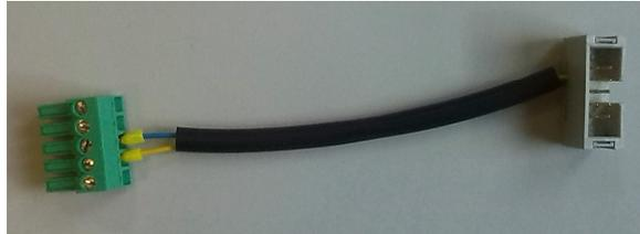
Questo cavetto, da usare quando il lettore è utilizzato in macchina in modalità CCTalk Seriale (non USB), viene collegato al cablaggio CCTalk della macchina ed alla morsettiera laterale del lettore di banconote. Non viene collegato al Flasher.
